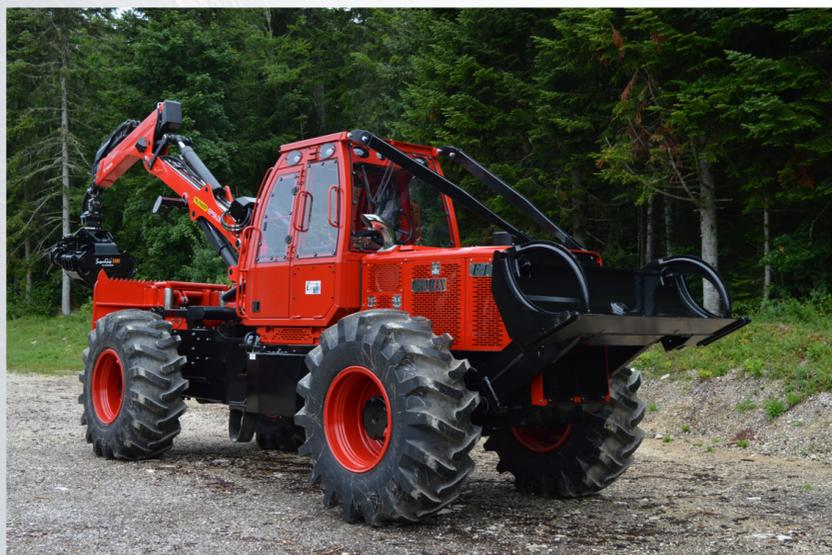
Avec sa boîte de vitesses POWER SHIFT, le F175 développe une force de traction de 231 k Nm
