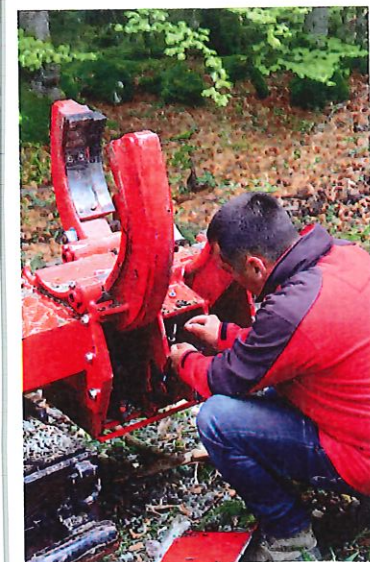
La vitesse de fermeture des bras et la pression des couteaux sont ajustables
